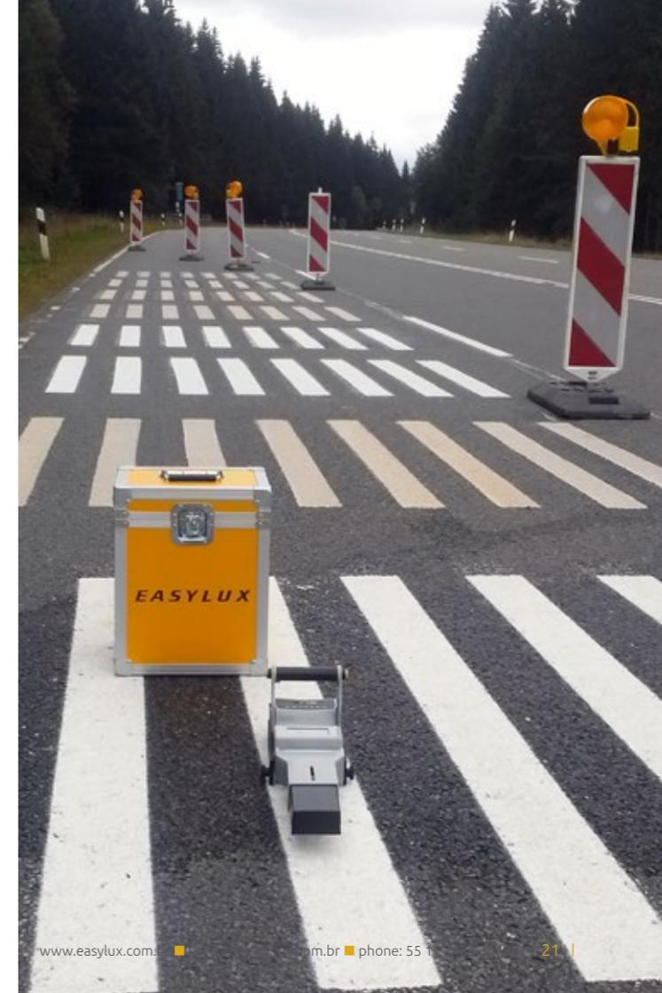
MiniReflecto Horizontal mide la visibilidad nocturna **RL**, la diurna **Qd** y la visibilidad con humedad **RL wet** y condiciones de humedad continua **RL rain** de señales viales en la geometría de 30-metros (15-metros opcional).
