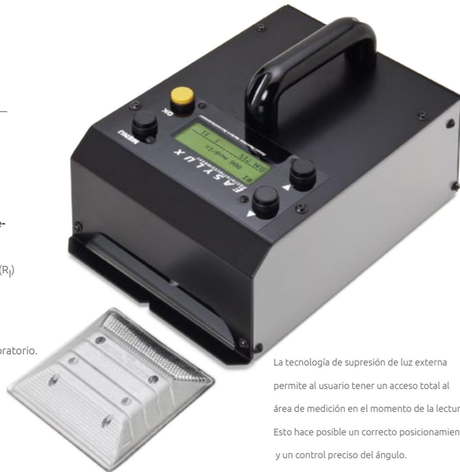
La tecnología de supresión de luz externa permite al usuario tener un acceso total al área de medición en el momento de la lectura. Esto hace posible un correcto posicionamiento y un control preciso del ángulo.
