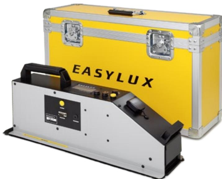
**EasyLux Horizontal clásico es un instrumento robusto, simple e intuitivo** que puede evaluar simultáneamente la visibilidad nocturna ( $R_L$ ), la diurna (Qd) y puede registrar la temperatura ambiente y la humedad relativa del aire con rapidez, facilidad y sin esfuerzo.
