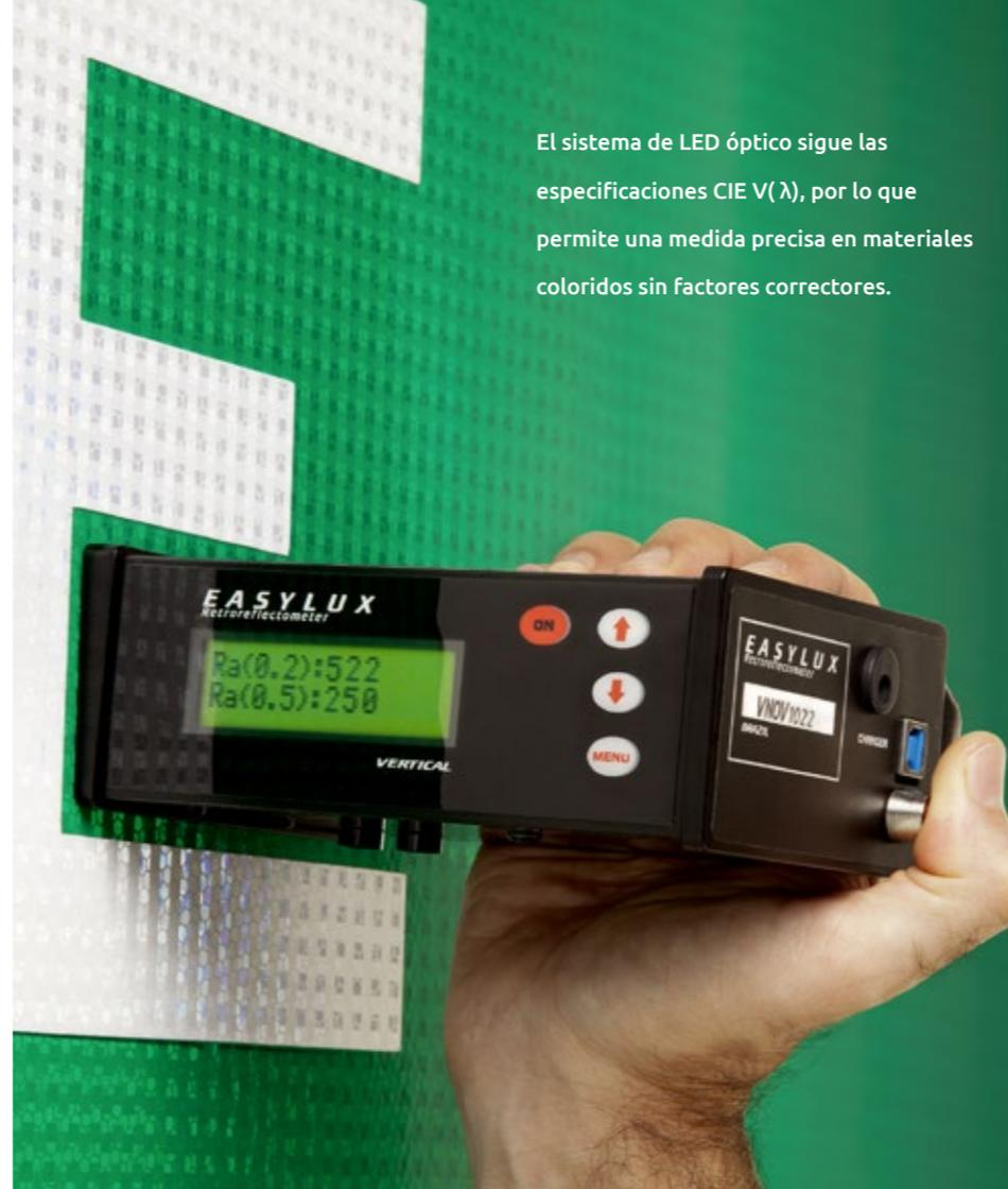
El sistema de LED óptico sigue las especificaciones CIE V( $\lambda$ ), por lo que permite una medida precisa en materiales coloridos sin factores correctores.
